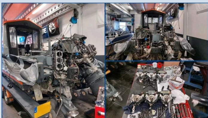
De motoren geheel uit elkaar voor onderhoud bij Vitali Watersport
